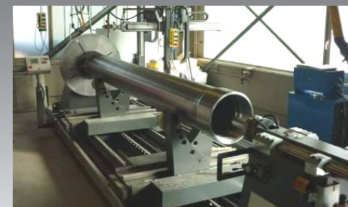
Instalação de solda automática sob pó
